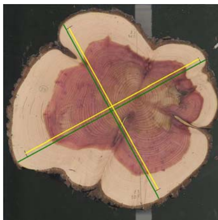
Figura 1. Representación gráfica de la metodología de medición de los dos diámetros cruzados en el periodo actual y hace 10 años.
