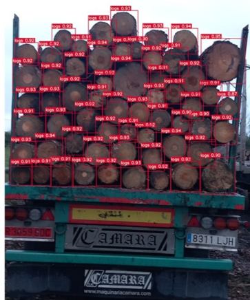
Paso 2: detección de trozas en el camión
